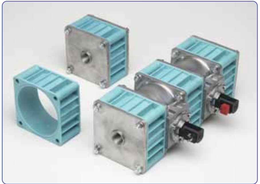
Speicherzwischenstücke aus langglasverstärktem PA einzeln und mehrfach verbaut für Luftspeicher.
