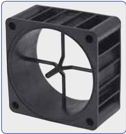
Speicherzwischenstück aus langglasverstärktem PA. ersetzt Alu-Druckgussteil.
